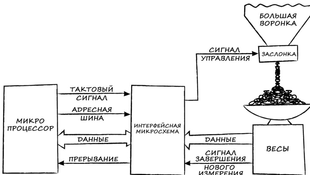
Рис. 3.1. Структурная схема контроллера управления задвижкой
